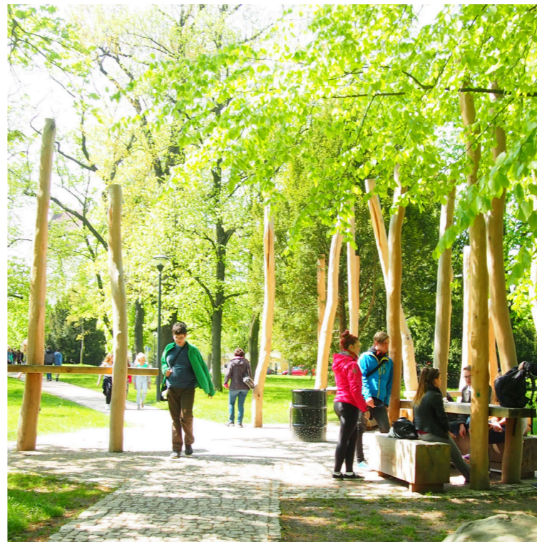
SVISLÉ KŮLY - VE VODĚ DUB, MIMO VODU AKÁT
